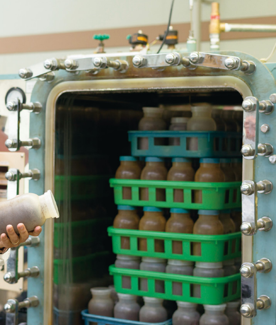
正確な試験結果を得るため、キノコを栽培するための瓶を釜で加熱し、雑菌を取り除く
