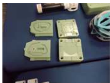
3D プリントで造形した簡易金型
