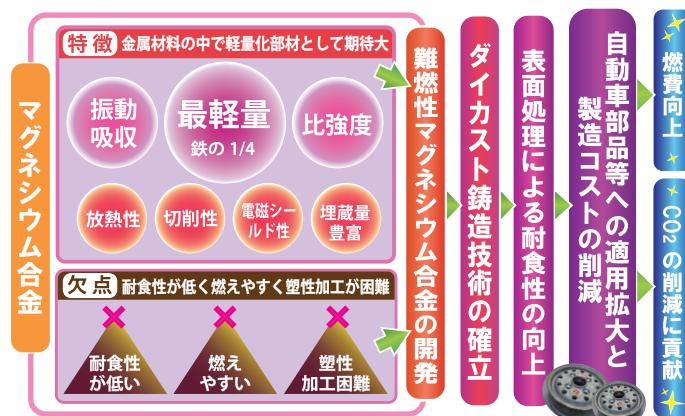
マグネシウム合金の特徴と研究により期待される効果
