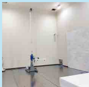
1mから4mまでスキャン可能な アンテナとアンテナマスト
