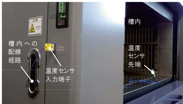
(a) 冷熱衝撃試験機 TSA-301L-W の槽外に付設した温度センサ入力端子と槽内への配線
