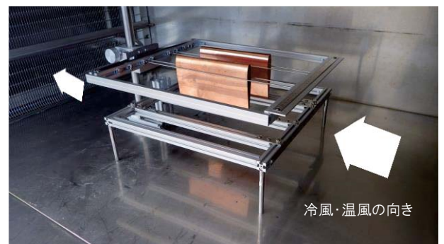
図1 フリージングパックを利用した簡易水浸型温度変化試験（冷熱衝撃試験機の槽内に供試体を取り付けた保持具を配置した様子）
