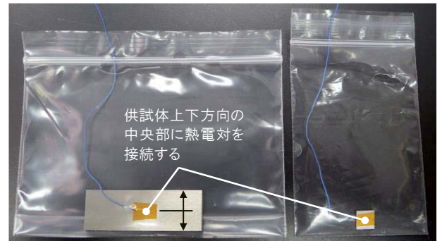
図 7 フリージングパックへの供試体の封入例
