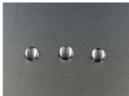
図 3 接触角測定 (試験片上の水滴)
