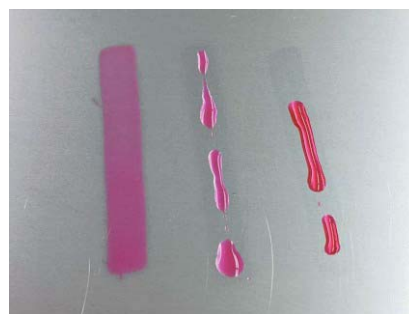
図8 ダインペンによるぬれ張力試験 (左：ぬれている 中央・右：ぬれていない)
