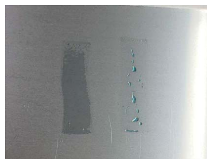
図 7 むれ張力試験
