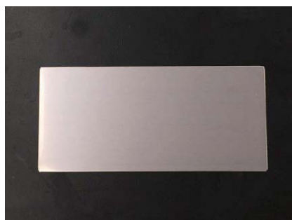
図 1 使用した SUS304 試験片
