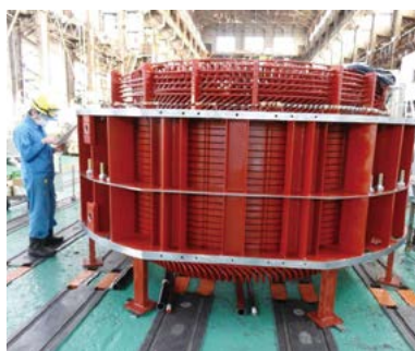
発電機固定子 (300kW増)
