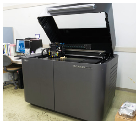
樹脂3Dプリンターでは、精密な細部と滑らかな表面を持つ三次元モデルが作製できる。使い勝手などを確認しながら、製品化につなげていく形状確認には、とても有効
