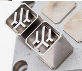
金属3Dプリンターで作られた試作品。金属3Dプリンターにより細かい形状の加工が可能となった
