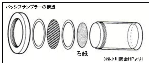
図5 パッシブサンプラーの構造
