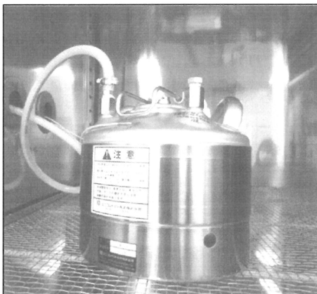
処理装置(恒温炉および耐圧容器)および圧力容器内での水熱処理
