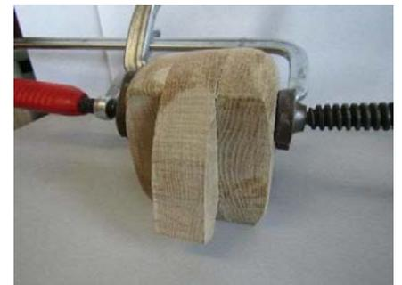
図7 接着時のクランプ止め
