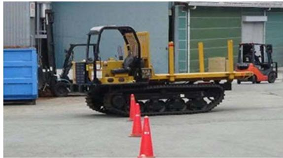
図2 旋回走行試験を行っている無人機
