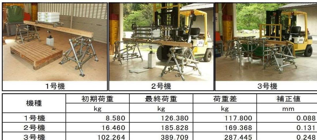
図表 1 製作した簡易曲げ試験装置の種類と積載荷重、支持台の補正值
