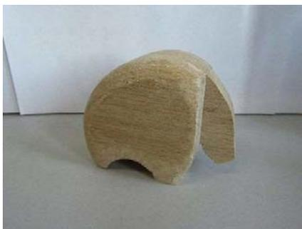
図8 鉄ヤスリによる丸みだし
