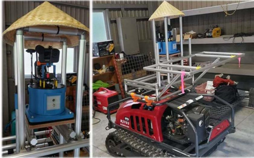
写真1 試作FPVカメラユニットと自走式草刈機
