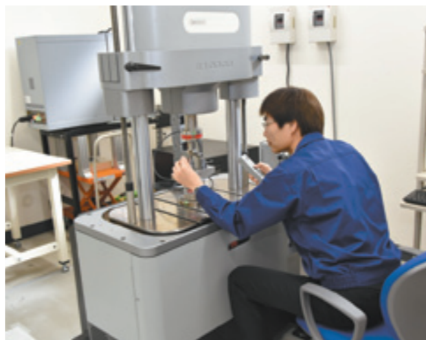
繰り返し力を加えることにより材料の劣化を評価する疲労試験機 (高度技術開発支援ラボ)
