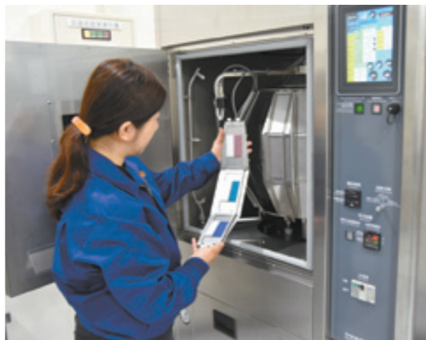
光により繊維の変色を評価する耐光試験機 (繊維製品品質強化支援ラボ)
