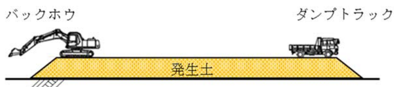
図2-4 (3) 塩島地区（河川側）発生土仮置き場における主な施工手順（発生土搬出）
