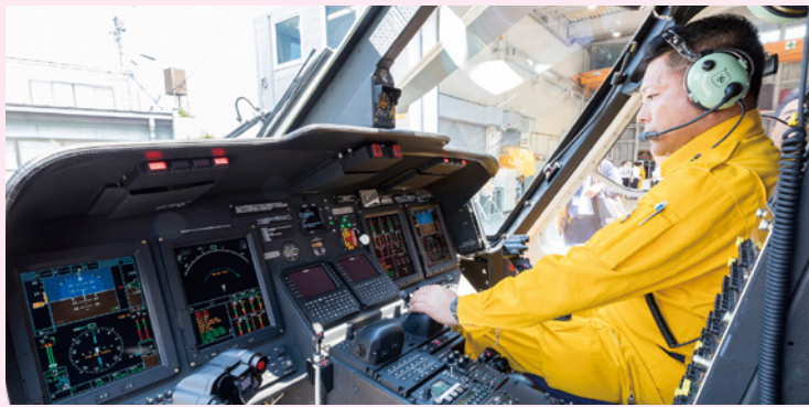
新「あかふじ」の操縦室は、最新のデジタルパネルが整備されているほか、旧「あかふじ」に比べ窓が大きくなっているので視認性も向上
