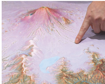
「赤色立体地図による富士山の立体模型」(アジア航測 作製) 地形の詳細な高低差が分かるほか、溶岩が流れる方向のシミュレーションもできる
