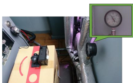
図2 水圧計のモニタリングの様子 (吹出し内は実際の撮影画像)
