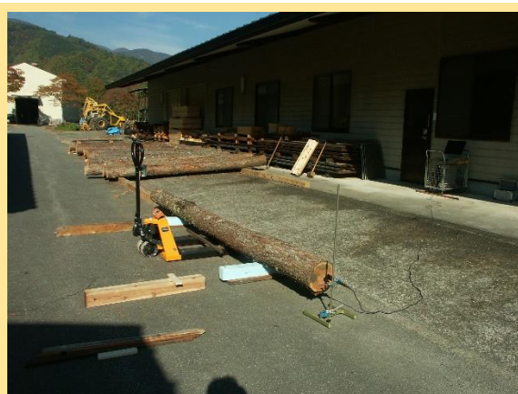
カラマツ丸太の打音検査による 縦振動ヤングの測定
