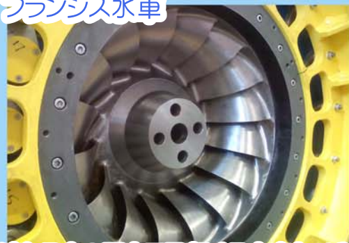
流れる水の圧力で回転する水車タービン
