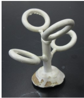
図4 セラミックシェルモールド法で鑄造したツリー
