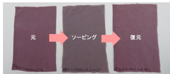
図 2 変色絹布の色彩復元（元・ソーピング・復元）
