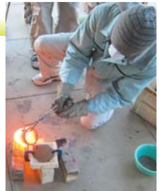
鑄込みの様子▶
