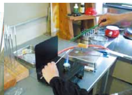
トンボ玉作り 棒ガラスをバーナーで溶かし、ステンレス棒に巻き取って作ります。
