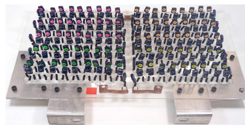
図 1 200 個直列電気二重層コンデンサバンク。静電容量 500 \mu F, 耐電圧 1 kV。
