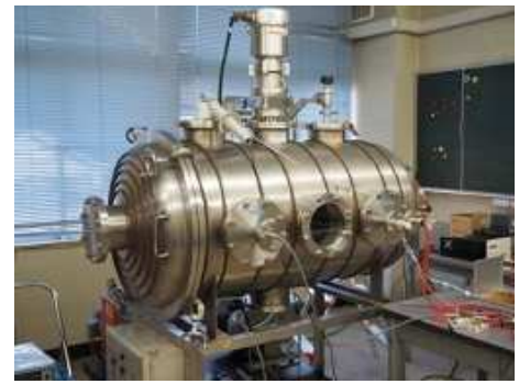
図 8 真空チャンバ. 直径 600 mm, 長さ 1,000 mm.
