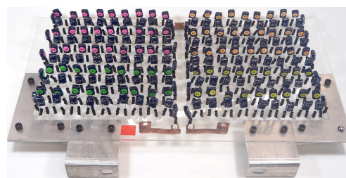
図 4 200 個直列電気二重層コンデンサバンク。静電容量 500 \mu F、耐電圧 1 kV。
