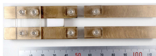
図 6 二段放電式パルスプラズマスラスト
