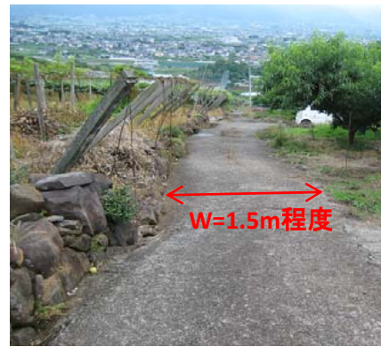
② 地区内の農道は幅員が狭く、農作業車両の乗り入れが困難であり、また路肩の陥没や舗装の老朽化により安全な走行に支障を来している。
