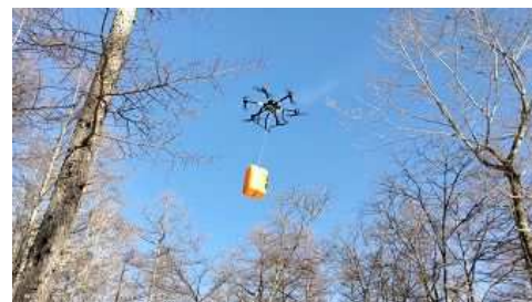
ドローンを用いた資材運搬
