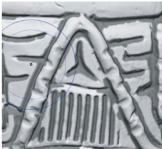
■ マスク箇所 ■ 非マスク箇所 図23 土器の溝部分をマスクした様子
