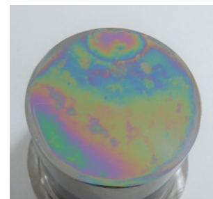
図2 超臨界CO 2 流体中洗浄後の金型表面の外観写真
