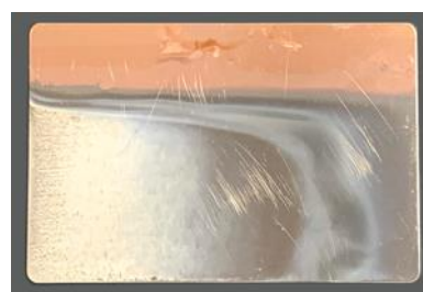
図7 隔膜を用いて Mn-Co めっきした試験片
