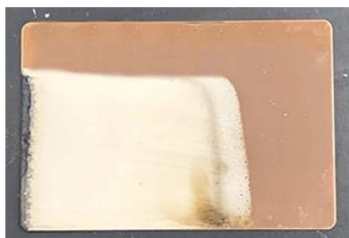
図5 隔膜を用いて Mn めっきした試験片
