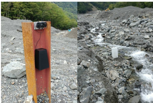
図5 画像観測ユニット（右）とIoT 観測装置（左）
