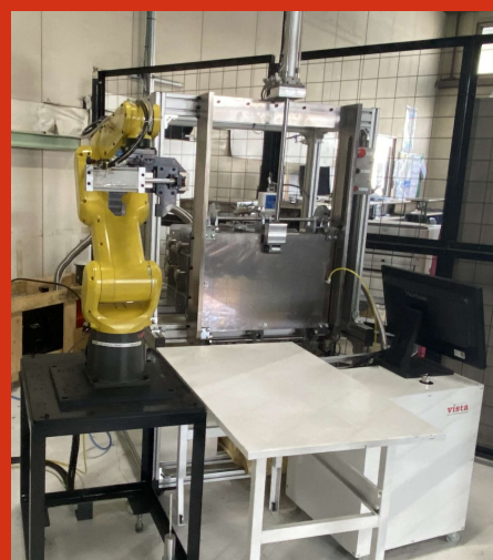
SLD-100を使った漏れ試験装置の例写真提供 (株)茂呂製作所殿
