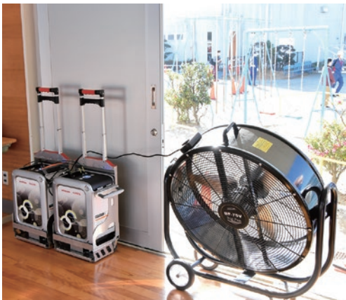
「Moving e」のバッテリーで動かした換気用の扇風機
