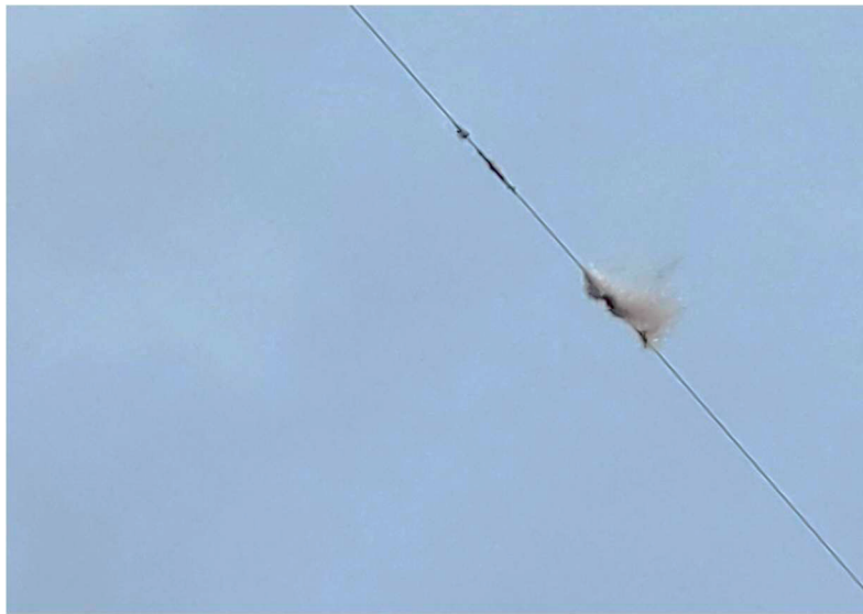
図3 黒色PEラインに絡みついた大型サギ類の羽毛（接触しても糸は切れていない）
