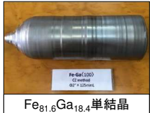
Fe 81.6 Ga 18.4 単結晶 近年開発された安価で磁歪効果の大きい磁歪材料
